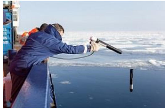
Pic2 : Déploiement de l'X-CTD depuis le pont du Polarstern
