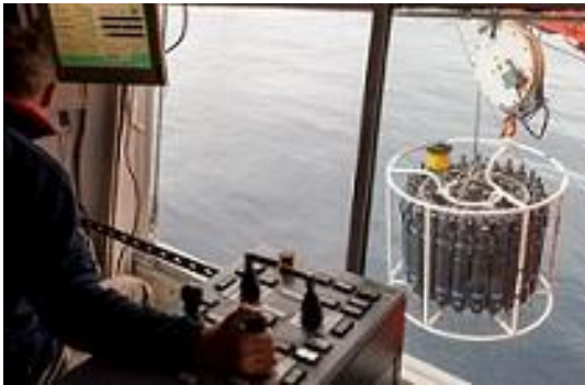
Pic1 : Déploiement de la Standard CTD depuis le pont du Polarstern
